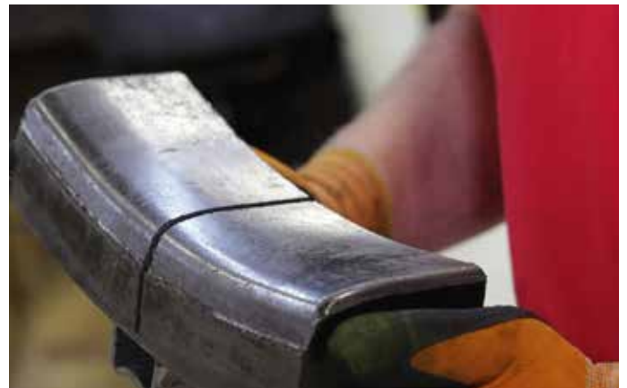
Die neuen Bremssohlen der DB bringen 10dB weniger Lärm.
