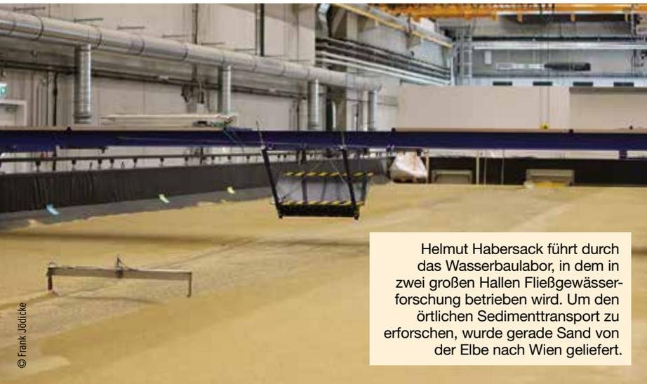
Helmut Habersack führt durch das Wasserbaulabor, in dem in zwei großen Hallen Fließgewässerforschung betrieben wird. Um den örtlichen Sedimenttransport zu erforschen, wurde gerade Sand von der Elbe nach Wien geliefert.
